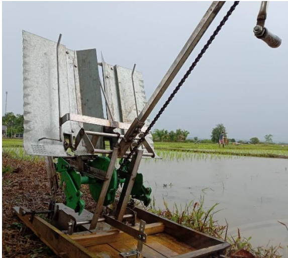
ภาพ 13 เครื่องปลูกข้าวระบบกึ่งอัตโนมัติแบบ 2 แถว
