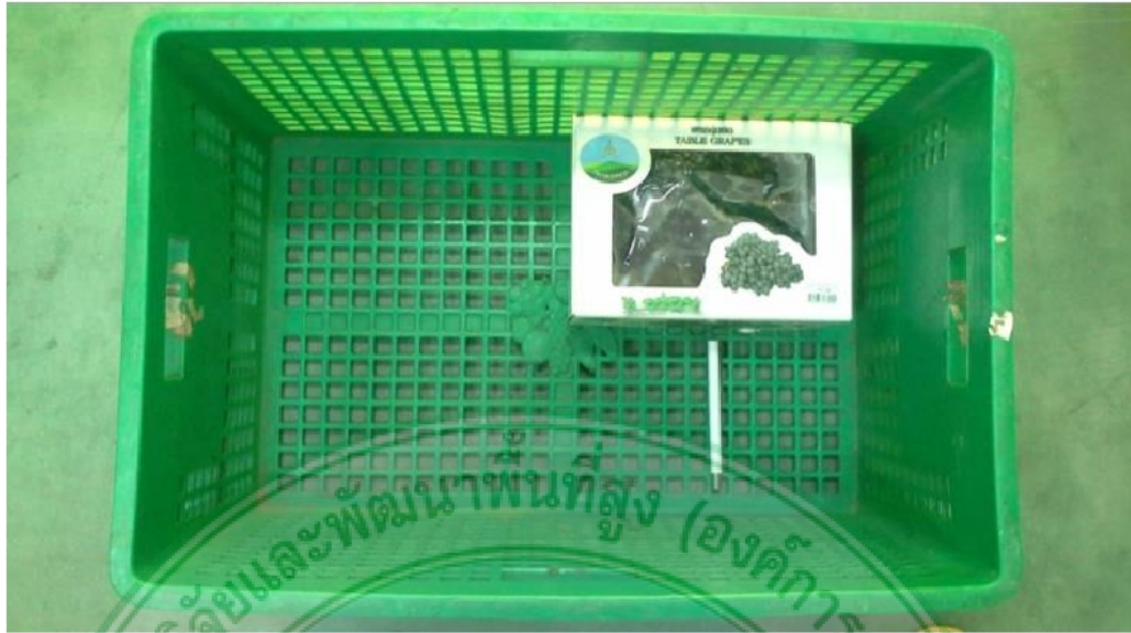
ภาพผนวกที่ 1 กล่องกระดาษโครงการหลวงเดิม สามารถบรรจุในตะกร้าพลาสติกเพื่อการขนส่งได้ 12 กล่องต่อตะกร้า คิดเป็นปริมาณองุ่น 6 กิโลกรัม
