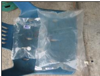
รูปที่ 21 ตัวอย่างถุงเก็บแก๊สที่ทำการบรรจุแก๊สที่ได้จากการเผาด้วยเตาซีวมวล
