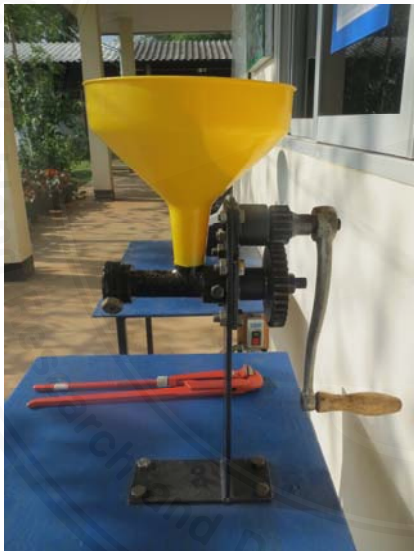
เครื่องหีบแบบสกรูอัดขนาดเล็กแบบใช้มือหมุน
