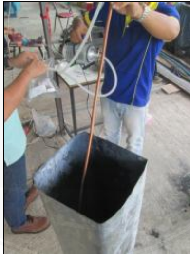
รูปที่ 20 ลักษณะการเก็บตัวอย่างแก๊สที่ได้จากเตาซีวมวล
