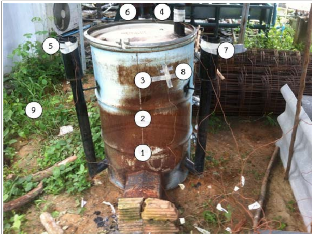
รูปที่ 14 ตำแหน่งในการวัดอุณหภูมิของเตาเผาถ่านแบบแนวตั้ง
