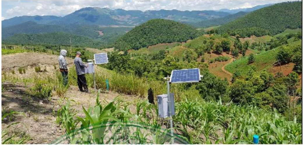
ภาพที่ 4.29 ติดตั้งสถานีตรวจวัด ความชื้นได้ดิน แรงดันน้ำในดิน และการเคลื่อนตัวของลาดดิน แม่มะลอ และตัวแทนสำนักงานโครงการฯ แม่มะลอ
