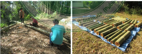
ภาพที่ 2: ขั้นตอนการตัดตัวอย่างลำไผ่เป็นท่อน ความยาวท่อนละ 1 เมตร
