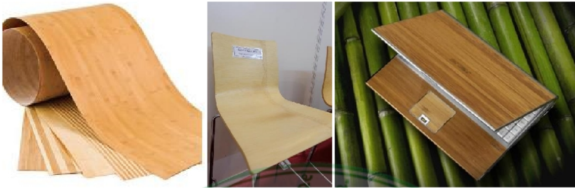
ภาพที่ 26 แผ่นไม้บาง (Veneer) ที่ผลิตไผ่ที่มีขนาดเส้นผ่าศูนย์กลางลำมาก และมีความหนาของผนังปล้องมาก สามารถนำมาผลิตเป็นเครื่องเรือนหรือเครื่องใช้ได้
