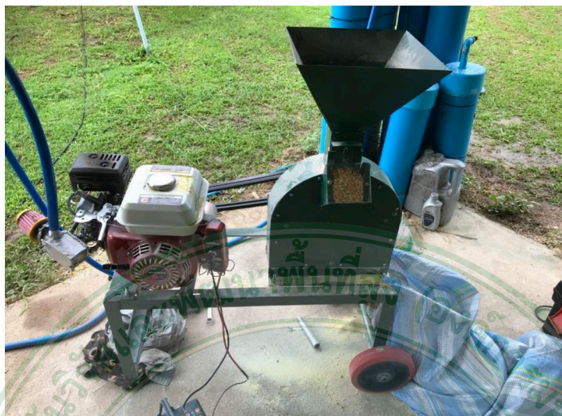
ภาพที่ 11 เครื่องบดเมล็ดข้าวโพดที่ต่อพ่วงจากเครื่องยนต์ที่ใช้ก๊าซชีวภาพ
