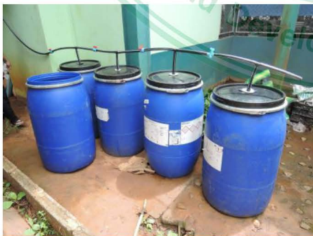
การทำบ่อหมักก๊าซชีวภาพแบบถัง 200 ลิตร ร่วมกับถุงพลาสติกฟู้ด
