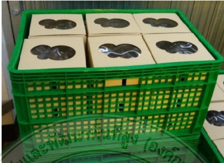
ภาพที่ 4.38 รูปแบบกล่องกระดาษลูกฟูกเมื่อจัดเรียงลงในลังพลาสติกเพื่อการขนส่ง
