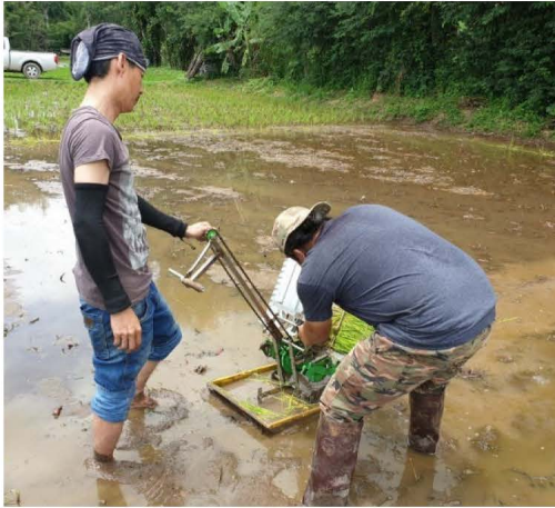
ภาพ 23 การทดสอบเครื่องปลูกในแปลงนาจริง
