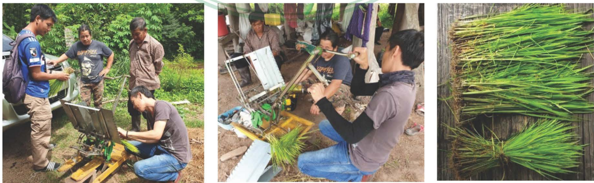
ภาพ 22 การปรับแก้ระบบกลไกการจับยึดต้นกล้า
