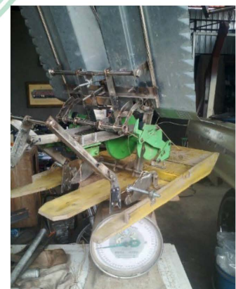
ภาพ 28 น้ำหนักรวมของเครื่อง ทั้งหมด 17 กิโลกรัม
