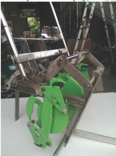
ภาพ 20 ภาพรวมของชุดโครงสร้างและอุปกรณ์ควบคุมการทำงานของเครื่องปลูกข้าวระบบกึ่งอัตโนมัติแบบ 2 แถว
