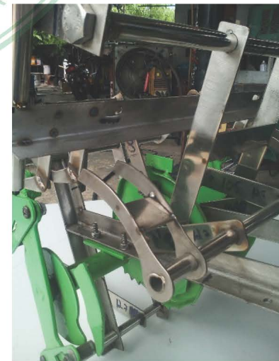
ภาพ 20 ภาพรวมของชุดโครงสร้างและอุปกรณ์ควบคุมการทำงานของเครื่องปลูกข้าวระบบกึ่งอัตโนมัติแบบ 2 แถว
