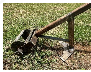
ภาพ 19 การจัดทำต้นแบบเครื่องกำจัดวัชพืช โดยการมีส่วนร่วมของเกษตรกรที่ทดสอบใช้งานจริง ในระหว่างพัฒนา/ปรับปรุง
