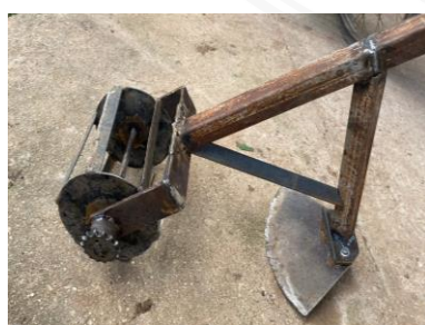
ภาพ 19 การจัดทำต้นแบบเครื่องกำจัดวัชพืช โดยการมีส่วนร่วมของเกษตรกรที่ทดสอบใช้งานจริง ในระหว่างพัฒนา/ปรับปรุง
