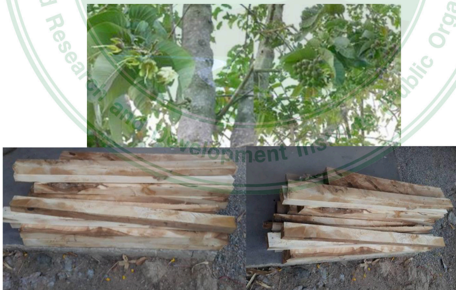
ภาพที่ 27 กิจกรรมการตัดไม้ตัวอย่าง (ลำพูป่า) เพื่อเตรียมทดสอบคุณสมบัติเชิงกลและคุณสมบัติด้านพลังงาน
