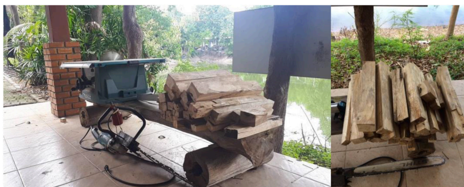
ภาพที่ 28 กิจกรรมการตัดไม้ตัวอย่าง (ก่อเดือย) เพื่อเตรียมทดสอบคุณสมบัติเชิงกลและคุณสมบัติด้านพลังงาน
