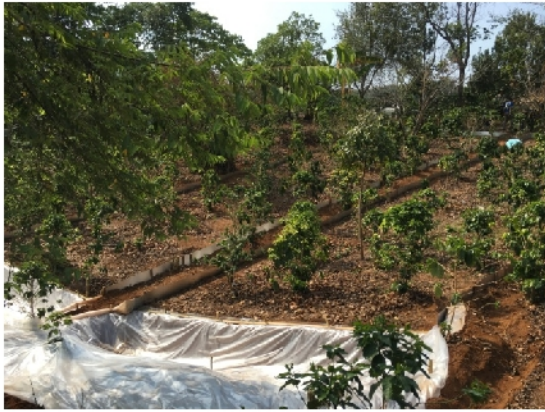
ภาพที่ 7 การจัดทำแปลงทดสอบการชะล้างหน้าดินในสวนกาแฟราบิกำบ้านดอยช้าง ทั้ง 4 แปลง
