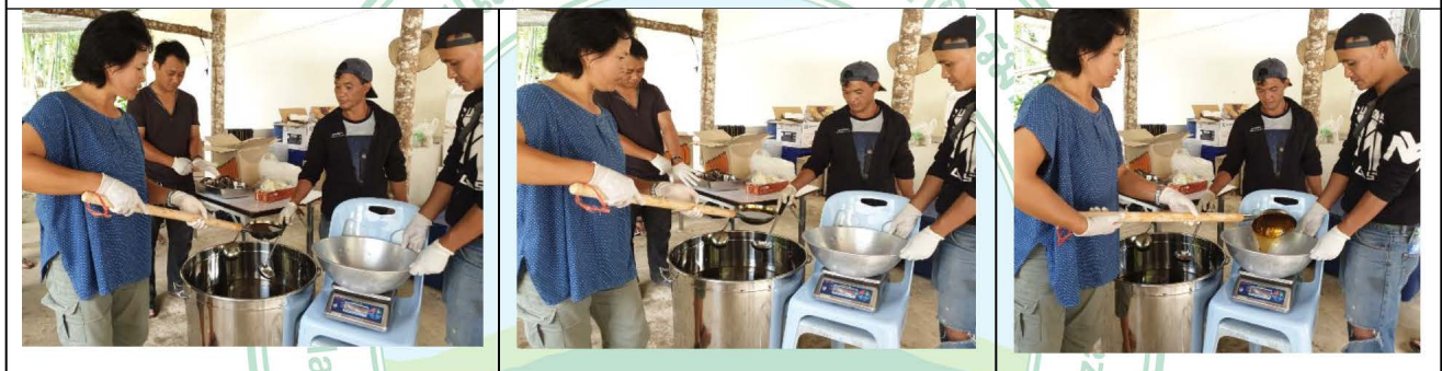
ภาพที่ 25 การทดสอบวิธีการลดความชื้นของน้ำผึ้งจากผึ้งโพรงเพื่อให้ได้คุณภาพ
