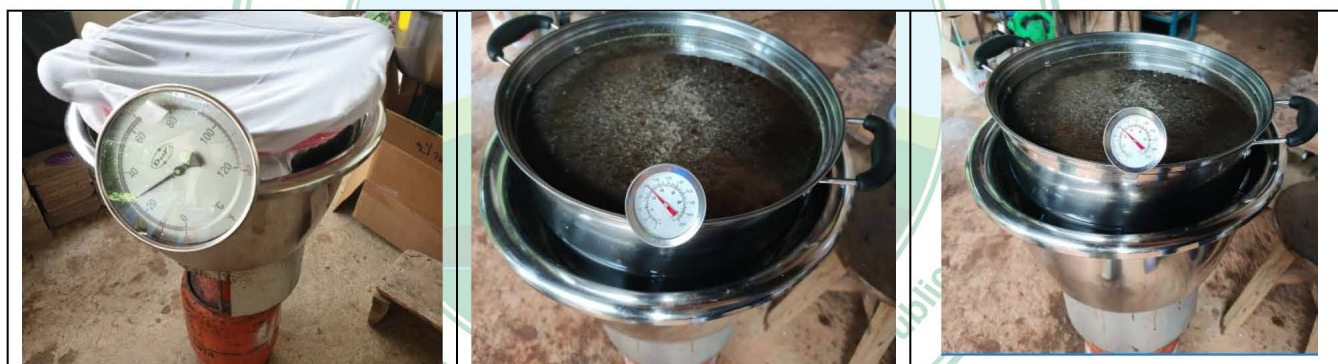
ทดสอบวิธีการลดความชื้นโดยใช้ถังระเหยความชื้นแบบเปิดที่อุณหภูมิ 55 และ 65 องศาเซลเซียส ภาพที่ 27 ขั้นตอนการทดสอบวิธีการลดความชื้นแบบปิดและแบบเปิดร่วมกับเกษตรกรบนพื้นที่สูง
