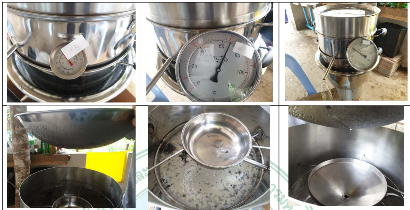
ทดสอบวิธีการลดความชื้นโดยใช้ถังระเหยความชื้นแบบปิดที่อุณหภูมิ 55 และ 65 องศาเซลเซียส
