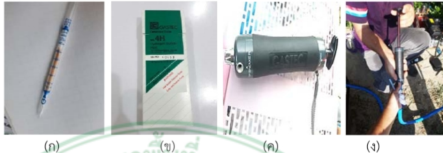
ภาพที่ 11 หลอดวัดปริมาณก๊าซไฮโดรเจนเซลล์ไฟต์ (ก) ชุดหลอดวัดปริมาณก๊าซไฮโดรเจนเซลล์ไฟต์ (ข) เครื่องวัดปริมาณก๊าซไฮโดรเจนเซลล์ไฟต์ (ค) และการวัดปริมาณก๊าซไฮโดรเจนเซลล์ไฟต์ (ง)
