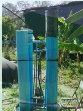
ภาพที่ 2 ชุดดูดซับคาร์บอนไดออกไซด์ เส้นผ่าศูนย์กลาง 6 และ 8 นิ้ว
