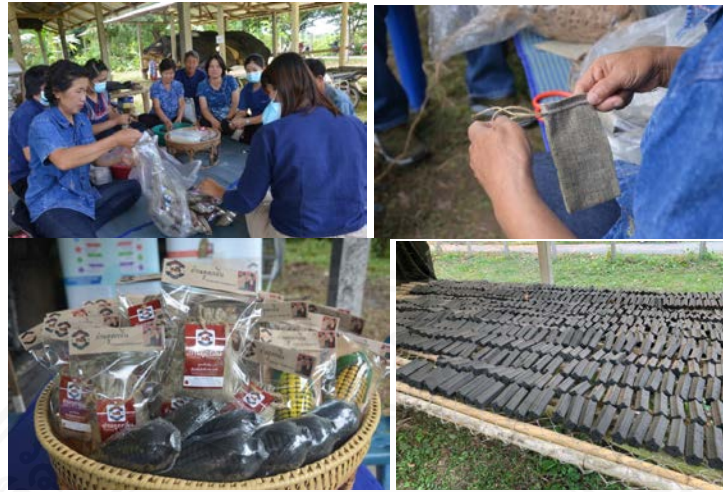
ภาพที่ 4-35 สมาชิกกลุ่มร่วมกันผลิตถ่านอัดแท่งและถ่านดุกกลินจากซังข้าวโพดทุกขั้นตอน
