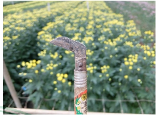
อุปกรณ์เก็บเกี่ยวมีลักษณะเป็นด้ามยาว 1-1.2 เมตร ส่วนปลายมีลักษณะเป็นใบมีดโค้งใช้สำหรับเก็บเกี่ยว
