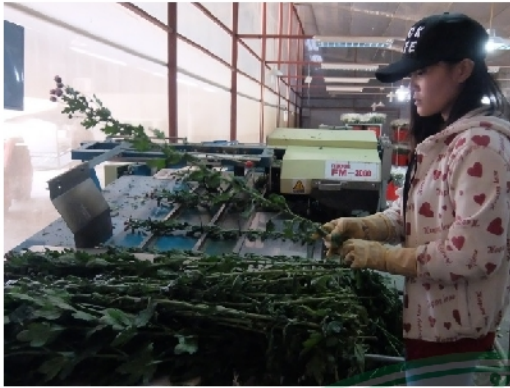
คัดคุณภาพและจัดชั้นคุณภาพดอกเบญจมาศด้วย เครื่องจักรคัดแยกอัตโนมัติ
