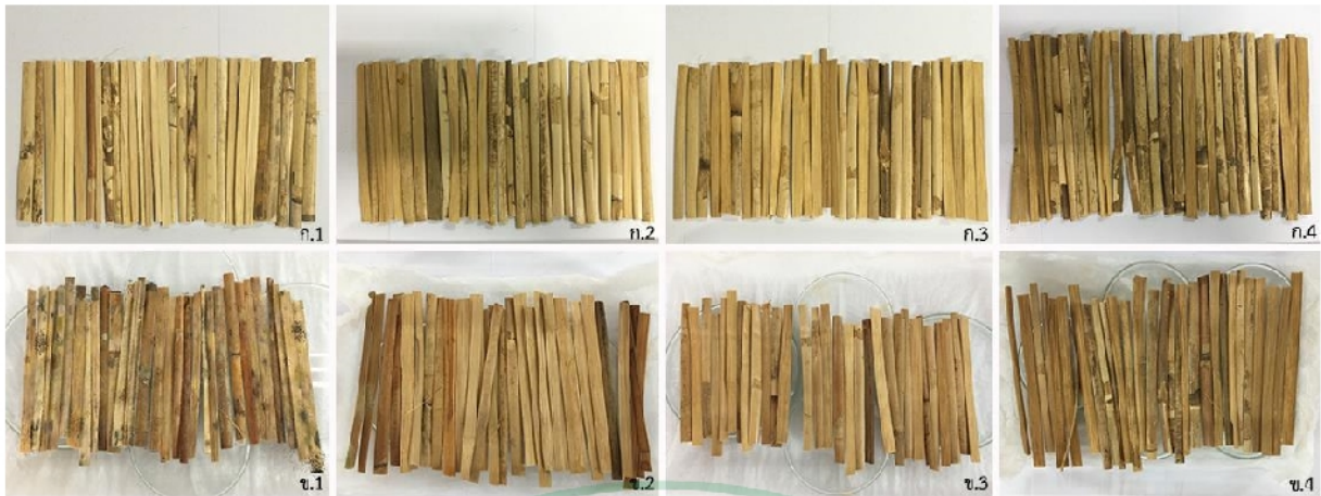
ไม่แช่ในน้ำส้มคว้นไม้ แช่ในน้ำส้มคว้นไม้: 25 % 50 % 100 % ภาพที่ 37 เส้นหวายหนามขาวหลังเก็บรักษาเป็นเวลา 1 เดือน จากกรรมวิธีที่ไม่ผ่านการแช่ในน้ำส้มคว้นไม้ (ก.1 และ ข.1) และผ่านการแช่ในน้ำส้มคว้นไม้ ที่ระดับความเข้มข้น 25 % (ก.2 และ ข.2), 50 % (ก.3 และ ข.3) และ 100 % (ก.4 และ ข.4) (ก: เส้นหวายในกล่องสภาพขึ้นก่อนบ่ม; ข: เส้นหวายในกล่องสภาพขึ้นหลังบ่ม เป็นระยะเวลา 5 วัน)
