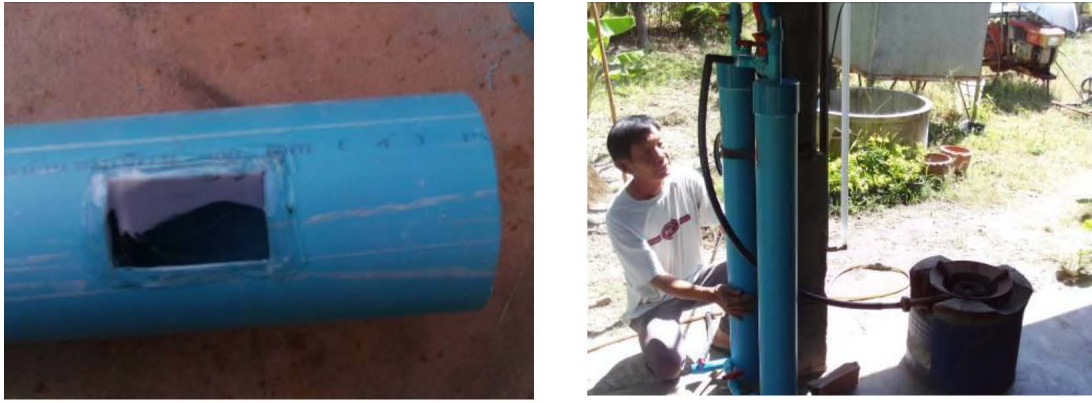
ภาพที่ 13 ช่องสังเกตการเปลี่ยนสีของตัวกลางดูดซับ
